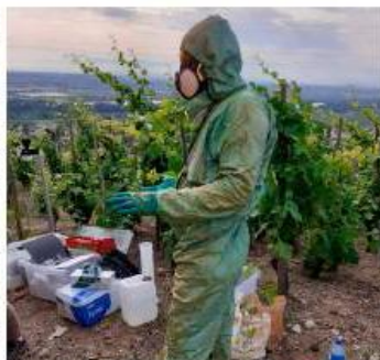
Le produit utilisé pour mesurer l'exposition des opérateurs était une même bouteille mère pour le drone et le pulvérisateur à dos, à savoir un colporteur alimentaire, la tartrazine, afin d'éviter les biais.
